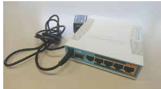
図5 hAP ac を利用した可搬型基地局 (2019 年版)
