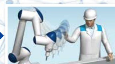
指や手の挟み込みを防止する構造、衝突時の自動停止機能
