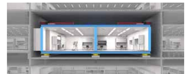
部屋免震システム
