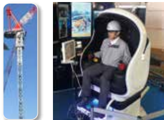
「TawaRemo ® 」(遠隔でのクレーン操縦)
