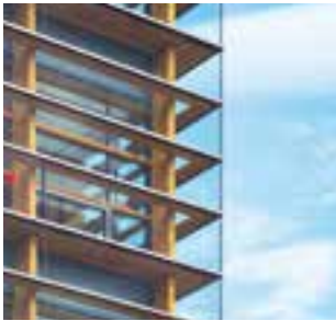
集成材で支持したダブルスキングが環境負荷を低減し、外部からも木の質感が感じられます。
