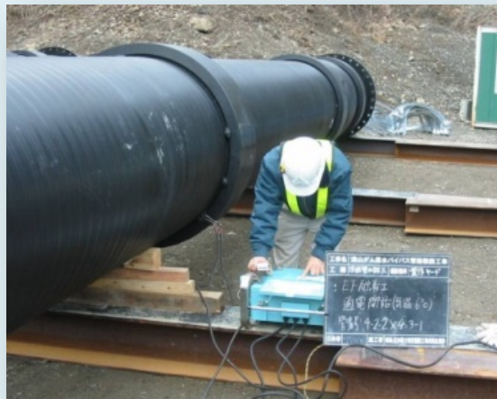
継手部の抜け出し・漏水なし
