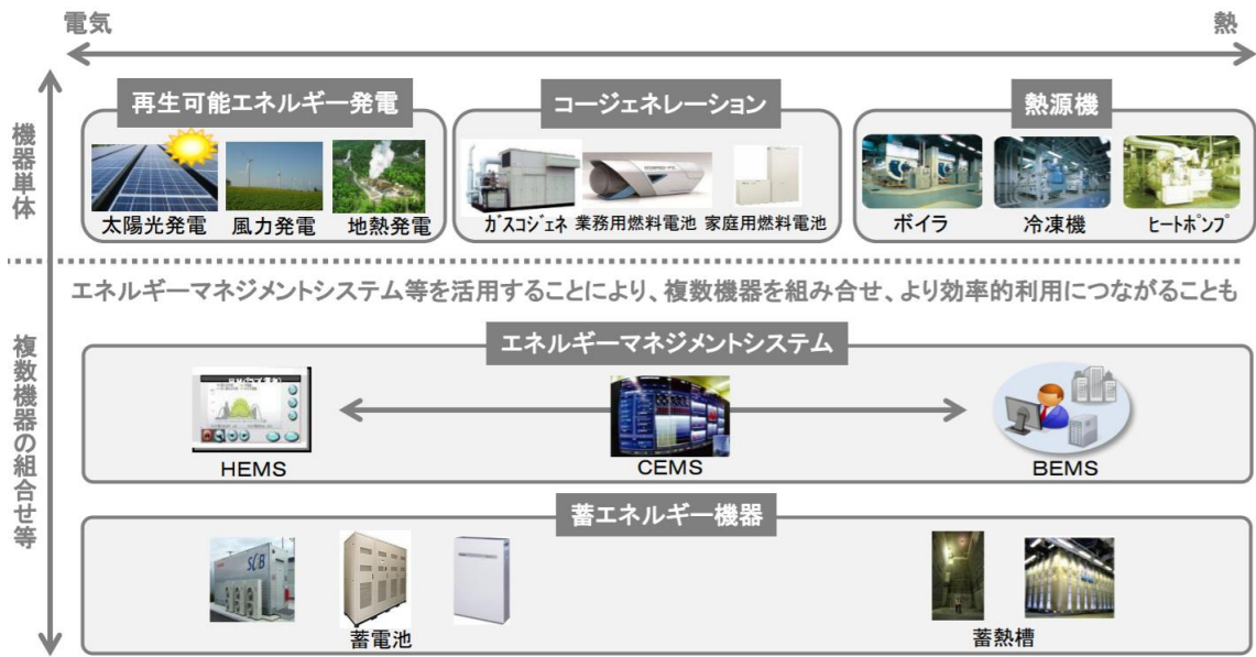
図 1-2 分散型エネルギーシステムにおけるエネルギーの供給形態 (出所) 総合資源エネルギー調査会 長期エネルギー需給見通し小委員会 (第6回会合) 資料1
