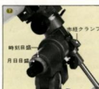
⑨ 極軸望遠鏡をのぞきながら、方位および高度調整微動ネジをまわしてスケールの小円に北極星を入れます。（下図）
