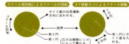
(例) ガイド望遠鏡の対物レンズの焦点距離が1000mmのとき、撮影用レンズの焦点距離により、どの円をガイド許容範囲として使うか。
