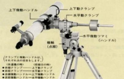
④ 水平動クランプと上下動クランプを少しうるめると望遠鏡を水平方向と上下方向に自由にうごかせます。このクランプをゆるめた状態でファインダーの視界内の十字線の交点附近に目的の星を入れてください。星が入ったら両方のクランプをしめます。
