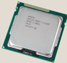
Core i3-2100Tなら、負荷が高いOCCT Perestroika 4.0.0の実行中でも56W前後。84WのACアダプターでも問題はない。
