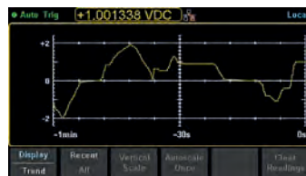
トレンド・チャート・モードでは測定値の時間変動グラフをストリップ・チャート表示
